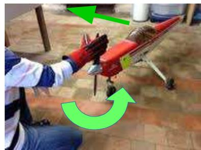
On peut sans doute expliquer ce sens de rotation par le fait que la personne le plus souvent droitier, qui démarre le moteur avec sa main droite (donc), va pouvoir plus facilement faire un mouvement tonique de la droite vers la gauche sur la pale qui se trouve au dessus de l'axe moteur, plutôt que le contraire...
