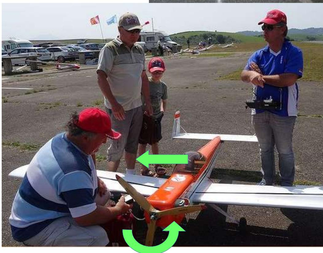
Le moteur et l'hélice tournent donc dans le sens anti-horaire vu de l'avant de l'avion (de face) et dans le sens horaire vu de l'arrière.
